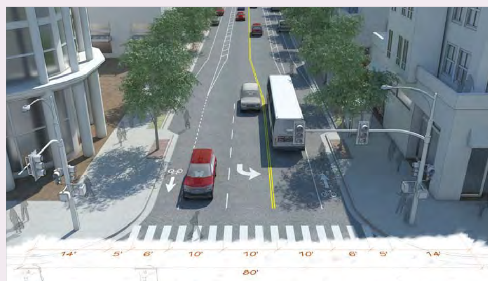
Figure 7: Illustrative concept with proposed right-of-way dimensions Figura 7: Sección ilustrativa con el concepto de las dimensiones que se proponen al derecho de vía
